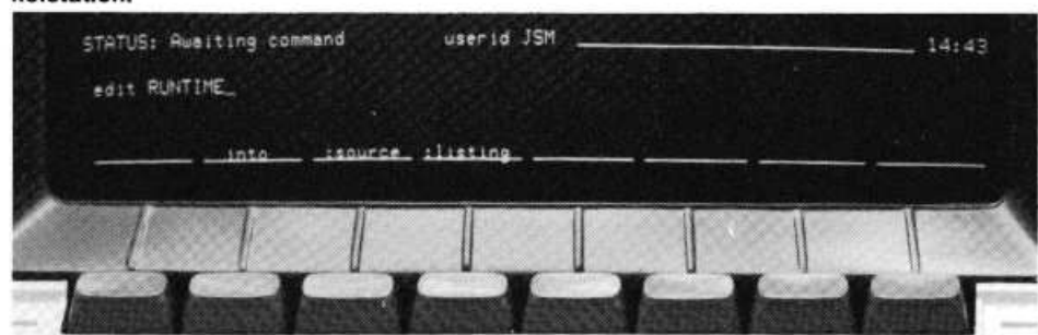
Afb. 4. Softkeys, gelabeld door syntax-gestuurde programmatuur, en – zodra functies zijn ingevoerd – nieuwe labels voor de softkeys worden afgebeeld op het scherm van het ontwikkelstation.
