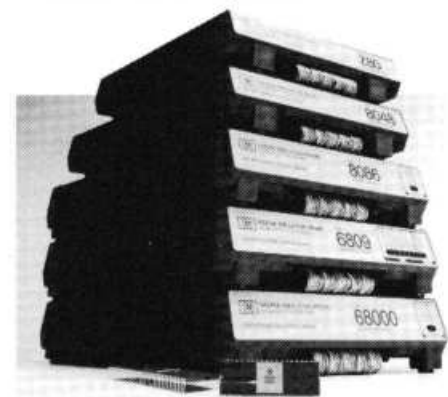
Afb. 5. Een verscheidenheid aan emulators voor 8 en 16-bit microprocessoren is beschikbaar voor gebruik op het universele HP 64000 ontwikkelsysteem.
